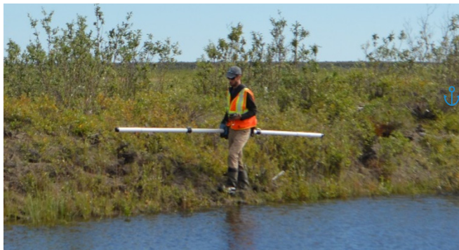
Figure 2 : L'EM-31 en service à Taglu C-42.
